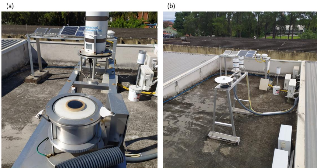
Figura 4.2. a) Em primeiro plano, o imageador LSV; b) visão da área experimental com os instrumentos instalados, também em primeiro plano, no cavalete.
