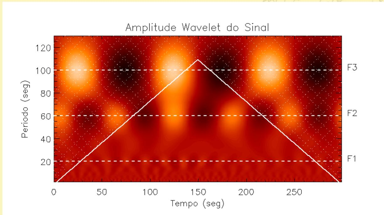
**Figura 4.** Espectro de amplitudes. F1, F2, F3, representam as frequências de interesse, as quais vão ser utilizadas ao calcular a transformada wavelet inversa.
