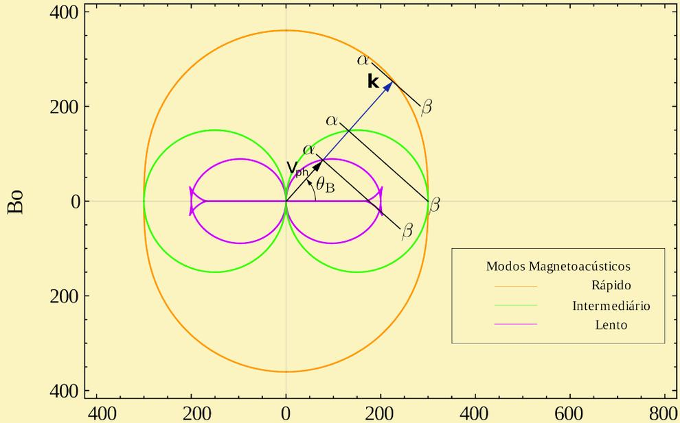
**Figura 1.** Diagrama de Friedrichs. Variação da velocidade de fase e de grupo em função do ângulo  $\theta_B$  para ondas com  $v_A > c_s$ .
