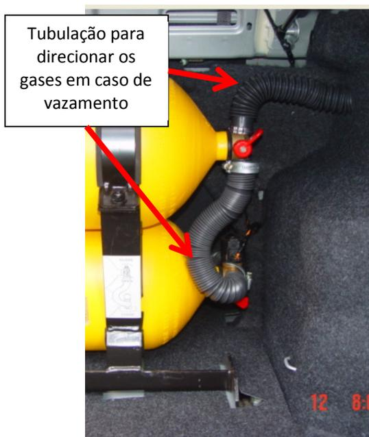
Figura 10 - DISPOSITIVOS DIRECIONADORES DE VAZAMENTOS DE GNV
