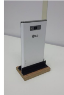
Foto 3 – Detalhe do Suporte para Manter o ESE na Vertical
