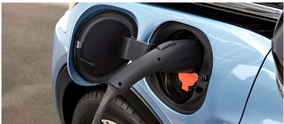
Figura 1 - Sistema de Carregamento Combinado (CCS) usado em modo CA. Imagem: NeoCharge.
