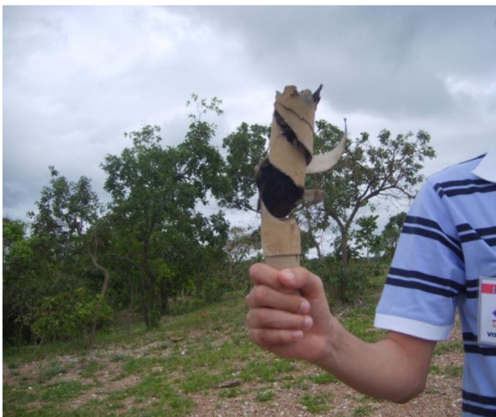
Foto 05: Aspecto do foguete que explodiu após ter sido submetido a condições extremas
