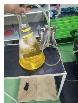
Bomba Pneumática mangueira de expelir combustível
