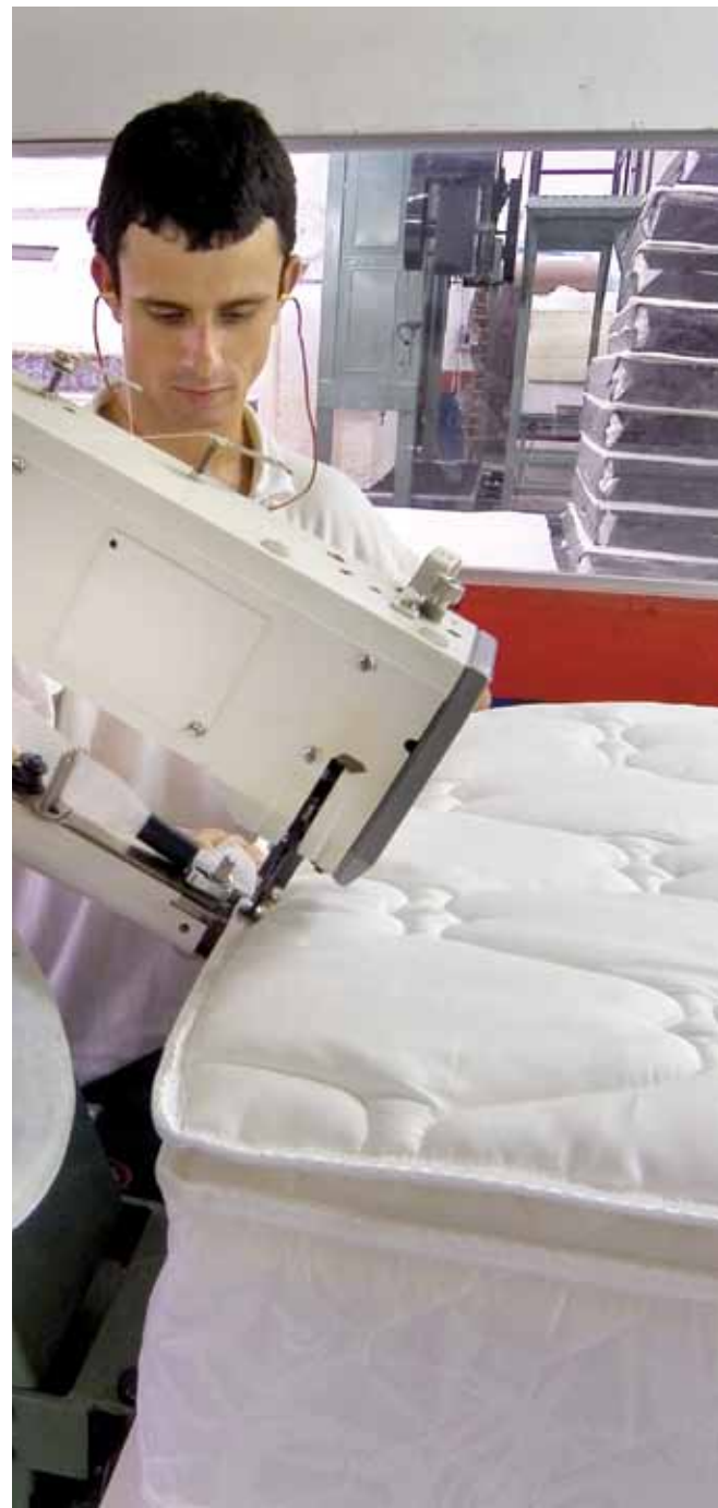
Máquina de fechar colchões: implantação assistida apoiou empresas do setor no preparo para o Programa de Avaliação da Conformidade
