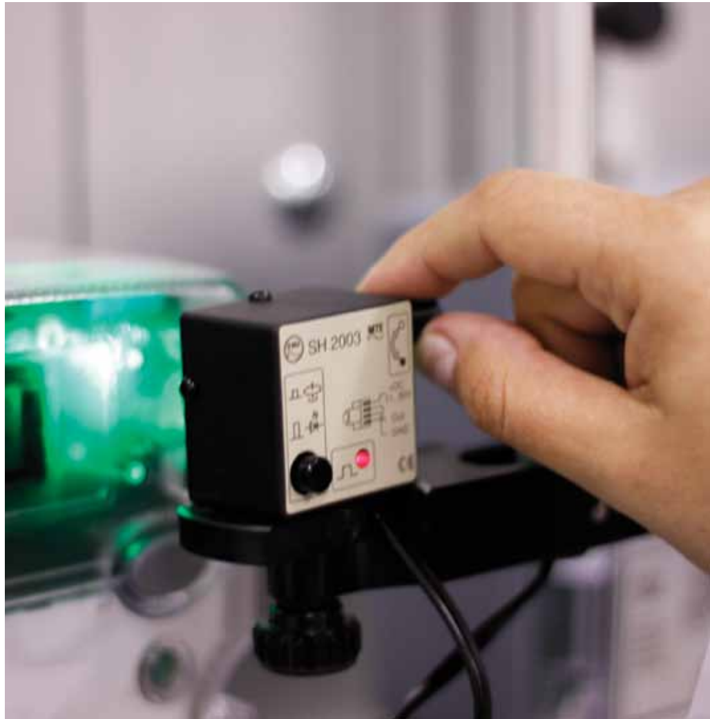
Ensaio para aprovação de modelo de medidor de energia elétrica
