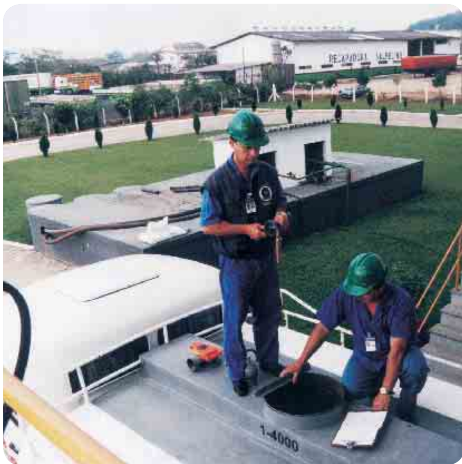
A arqueação de tanques e a verificação de bombas medidoras de combustível fazem parte da rotina dos fiscais da rede de IPEMs estaduais
