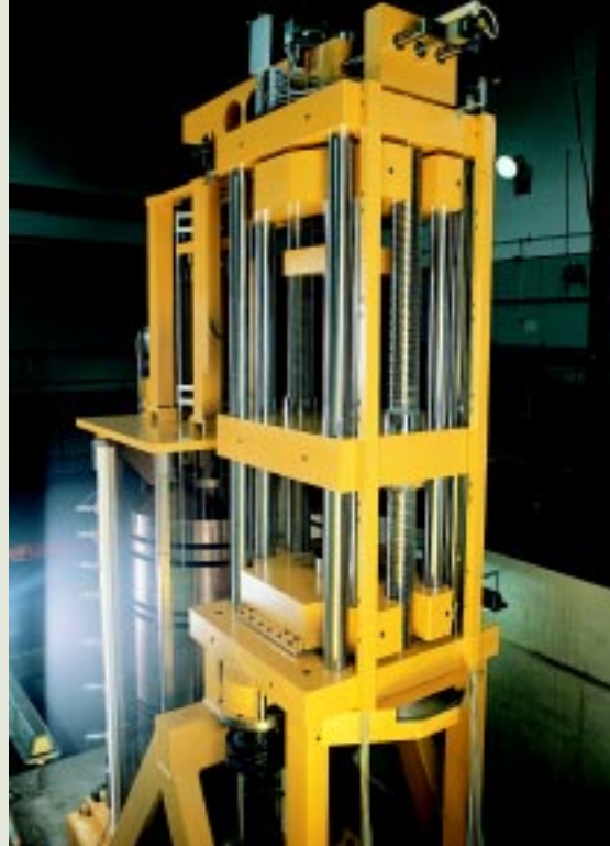
Máquina de padronização primária de força por peso morto.
