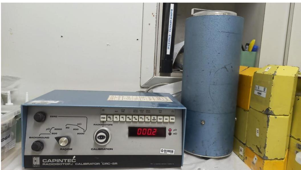
Figura 21: fotografia do calibrador de dose utilizado nos experimentos
