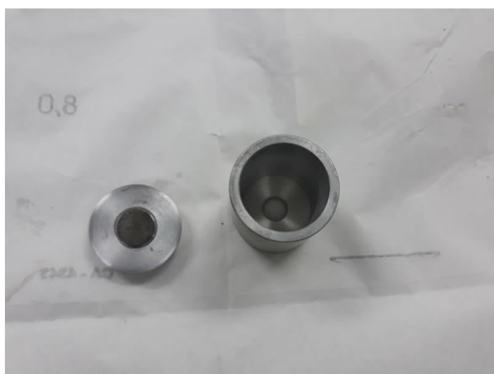
Figura 14: Na figura, à esquerda, o alvo de bismuto já encaixado no centralizador de Al. Na mesma figura à direita aparece o suporte onde será encaixado o conjunto com o alvo e juntos serão acoplados no porta alvos. Fonte: O autor (2022).
