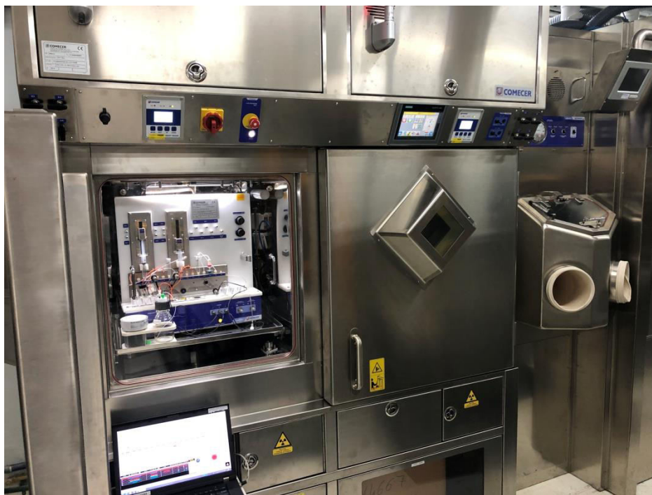
Figura 9: Equipamento usado para extração chamado de hot cell com módulo de síntese em seu interior. Fonte: O autor (2022).
