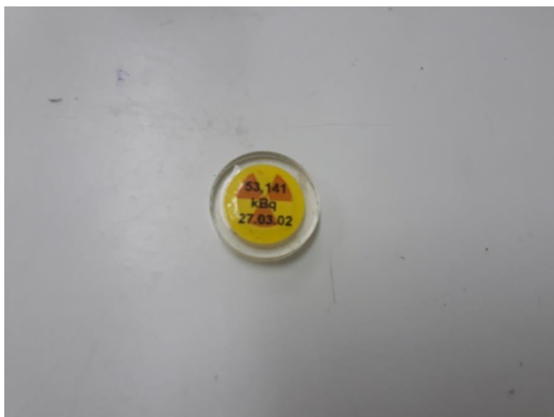
Figura 17: Fonte calibrada de Európio 152 encapsulada em acrílico.
