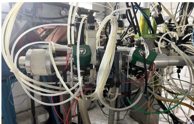
Figura 5: Linha de feixe secundária e acoplamento do alvo.
