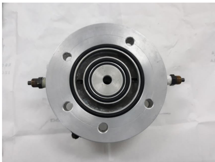
Figura 15: Interior do porta alvos com o alvo de bismuto inserido no suporte de alumínio.
