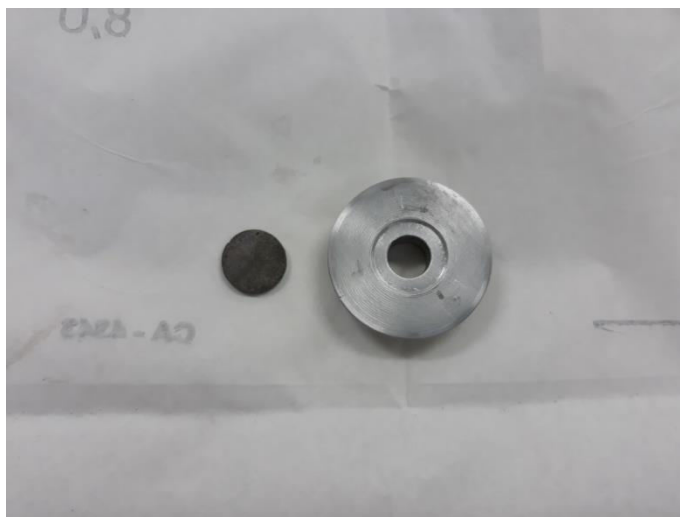
Figura 11: Amostra de bismuto à esquerda e à direita o centralizador de Alumínio.
