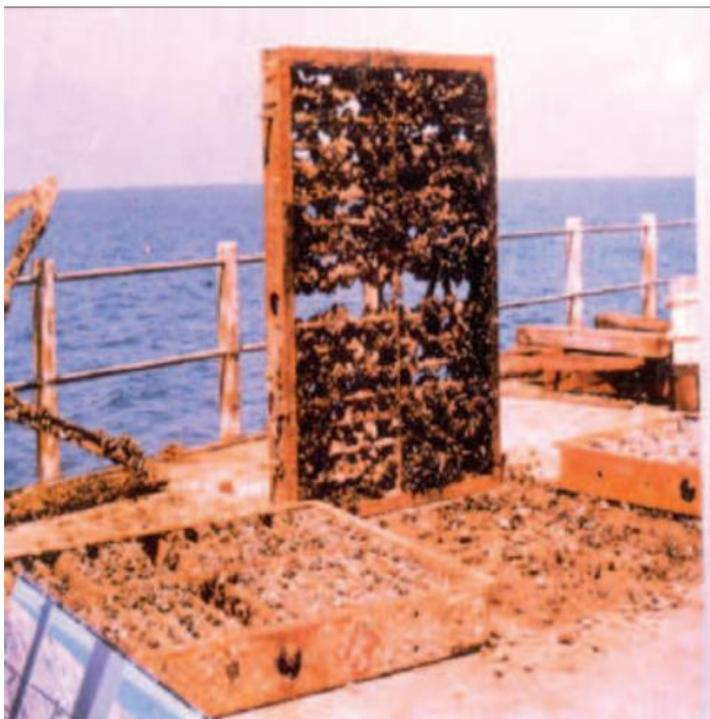
Figura 10: Biofouling nas telas fixas de MAPS
