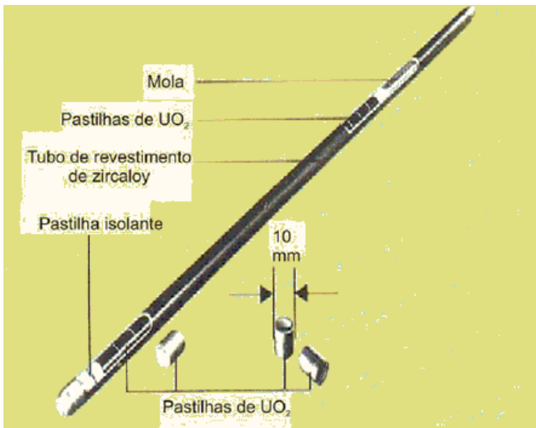
Figura 3.7: Vareta combustível - Ilustração Eletrobrás.
