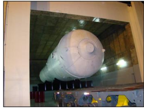
Figura 10: Gerador de vapor armazenado Fonte: ELETRONUCLEAR (2022)
