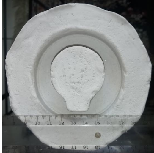
Figura 3.10: Molde em gesso criado para deposição do chumbo derretido com régua graduada posicionada para permitir a percepção das dimensões da peça confeccionada [Pontes, 2022].
