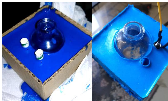
Figura 3.9: Preparação de negativo em silicone líquido: à esquerda com frasco e canudos de papel inseridos e, à direita, teste de posicionamento com os tubos Geiger-Müller inseridos [Pontes, 2022].
