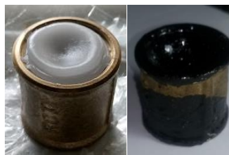
Figura 3.17: Luva de aço galvanizado de 1” contendo amostra de parafina (à direita) e asfalto (à esquerda) no interior [Pontes, 2022].
