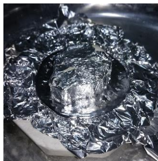
Figura 3.11: Molde contendo chumbo derretido sobre folha de papel alumínio no molde de gesso [Pontes, 2022].
