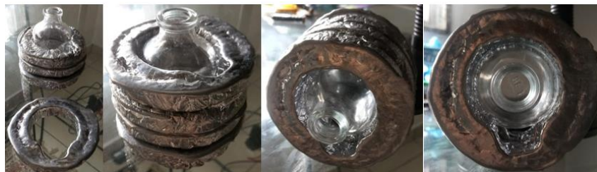
Figura 3.14: Montagem final dos anéis soldados com estanho: as fotos mostram, sob diferentes ângulos, o frasco de penicilina inserido no interior da blindagem de chumbo [Pontes, 2022].
