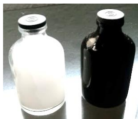
Figura 3.16: Frascos de amostra de penicilina contendo parafina (à esquerda) e asfalto (à direita) [Pontes, 2022].
