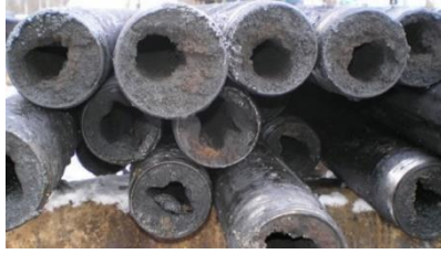
Figura 2.18: Obstruções parciais por asfaltenos em dutos [tecpetro.com.br, 2021].
