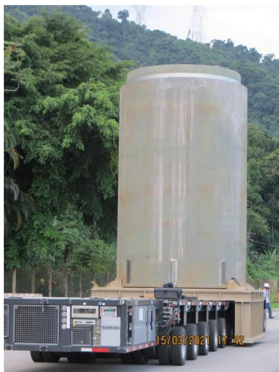
Figura 18: Transporte do HI-STORM para o UAS
