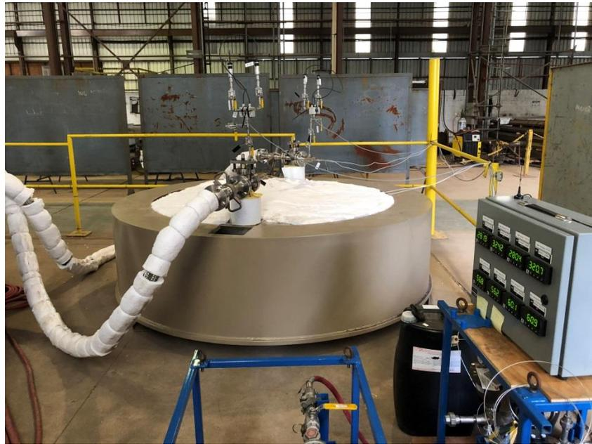
Figura 13: MPC simulado com conexões e equipamentos de medição e monitoramento
