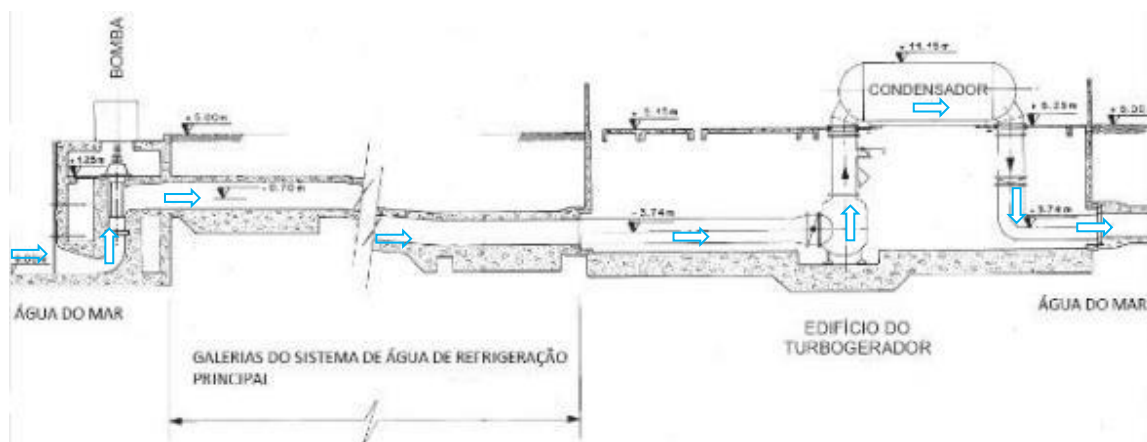
Figura 7: Percurso da Água de Refrigeração Principal (mar)
