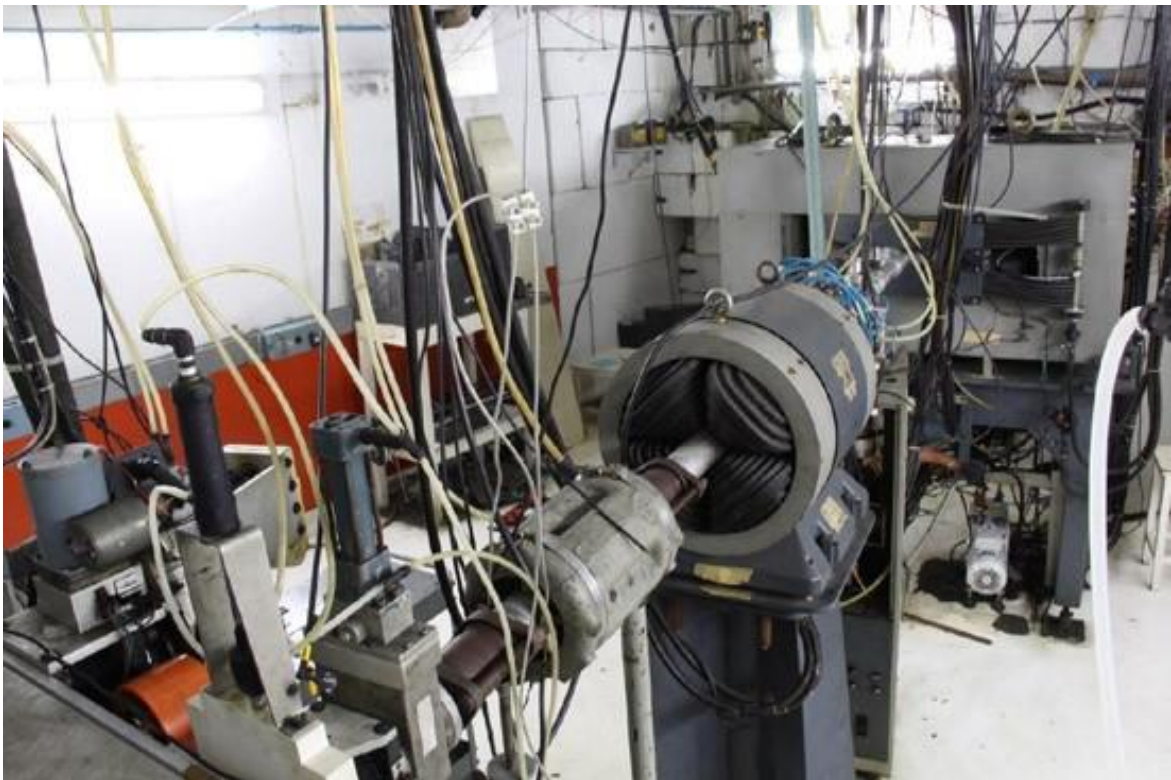
Figura 4 - Linha principal do CV-28: lente quadripolar e distribuidor magnético (Lemos, 2016).
