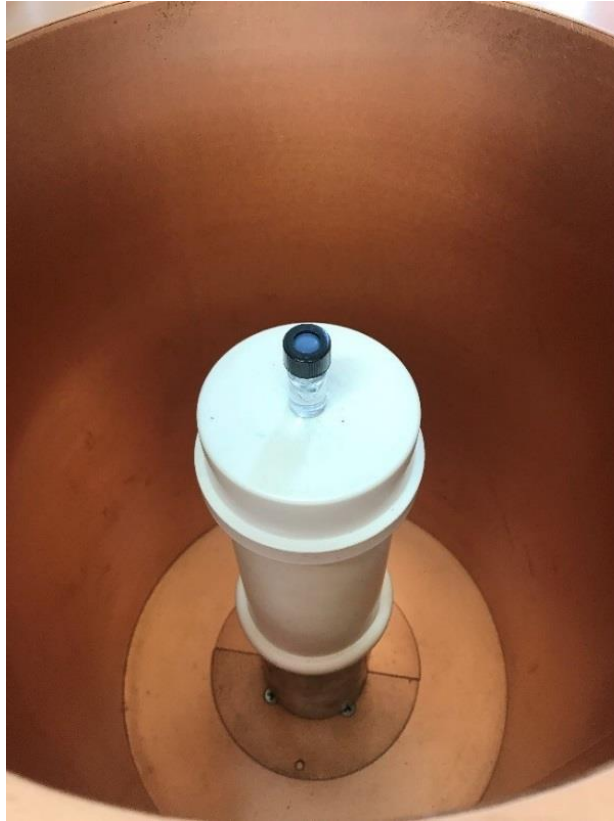
Figura 15 - Amostra de ^{123}\text{I} posicionada a 20 cm sobre o detector HPGe presente nas instalações da divisão de radiofármacos do IEN. (AUTOR 2020).
