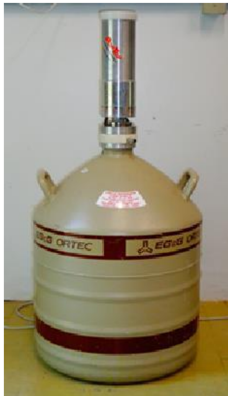
Figura 12 - Detector de germânio de alta pureza, modelo axial, resfriado a nitrogênio líquido, utilizado em técnicas de espectrometria X e gama, em medições de laboratório.
