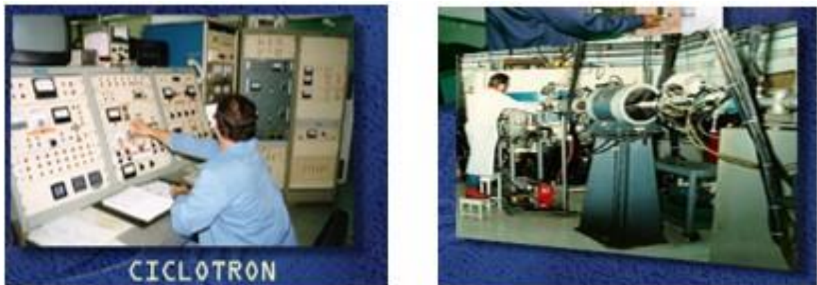
Figura 5 - Detalhe da Mesa de controle do CV-28 (à esquerda) e linha principal de irradiação (à direita) (Fonte: relatório interno).
