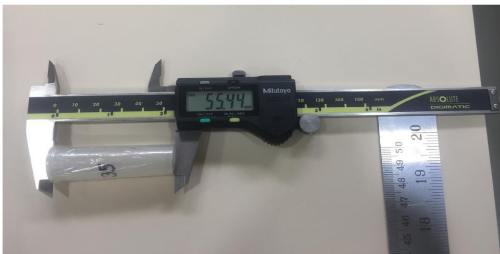
Figura 10: Paquímetro digital Mitutoyo, com 2 casas decimais de precisão.
