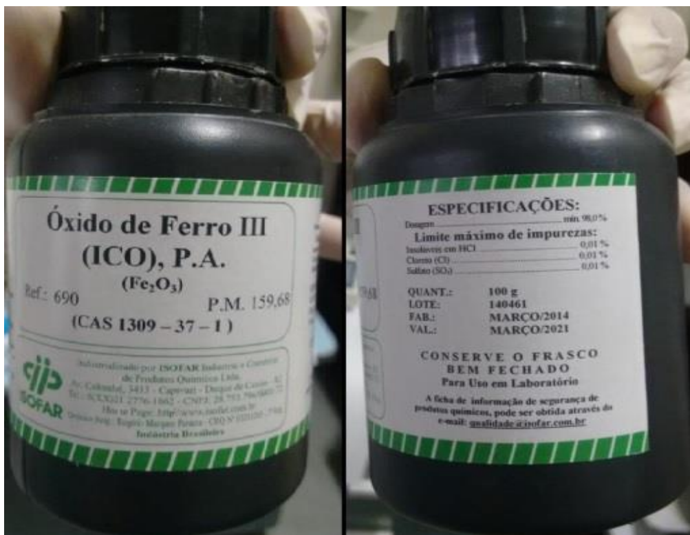
Figura 8: Óxido de ferro tipo III, com 98% de pureza.
