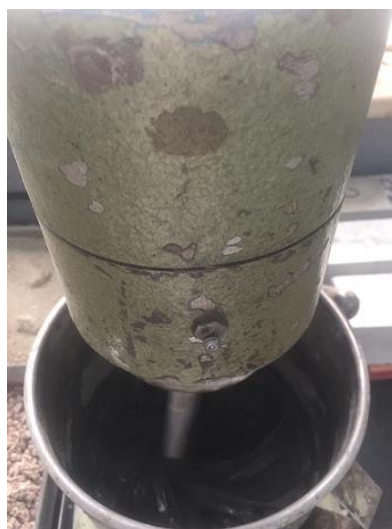
Figura 18: Misturador de argamassas durante a produção da calda de cimento.
