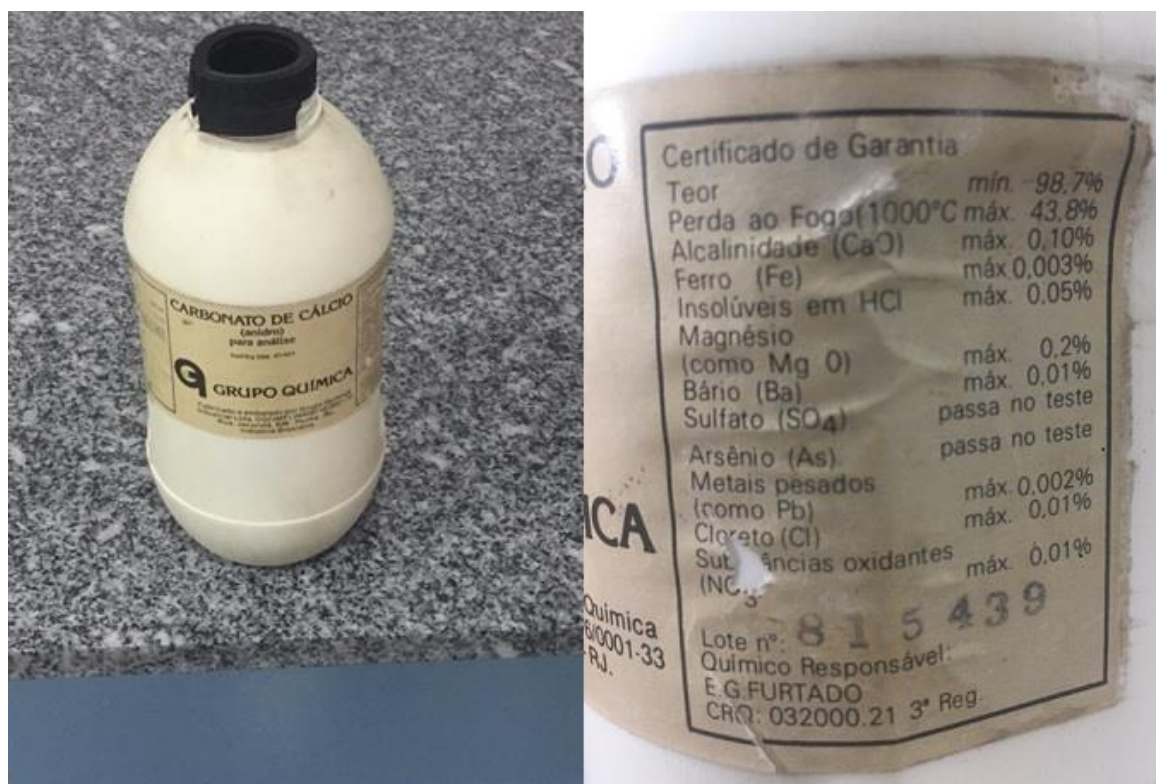
Figura 7: Carbonato de Cálcio, com 98,7% de pureza.
