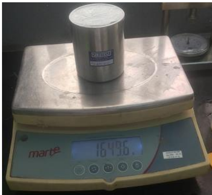
Figura 19: Pesagem da calda de Cimento Portland V com o recipiente.
