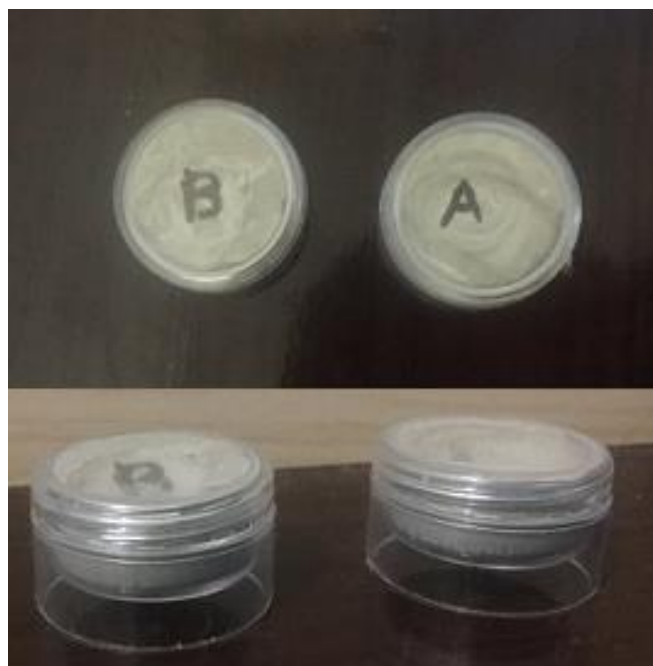
Figura 20: Recipientes de acrílico A e B, com as amostras da calda de cimento Portland V.
