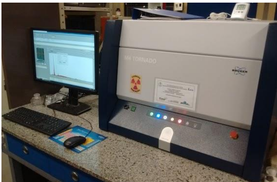
Figura 21: Equipamento de microfluorescência de raios X, Bruker M4 Tornado.
