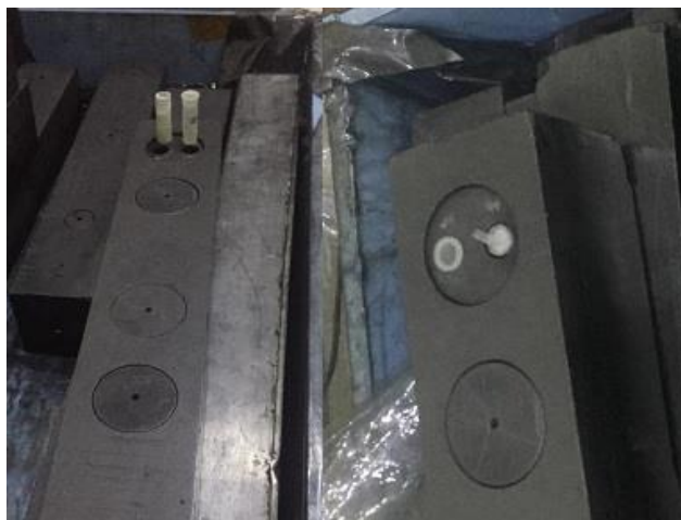
Figura 16: Porta amostras posicionado fora e dentro do bloco de grafite que é inserido no canal J9 do reator Argonauta.
