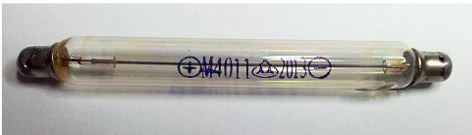
Figura. 6 – Tubo Geiger-Müller utilizado nesse protótipo.
