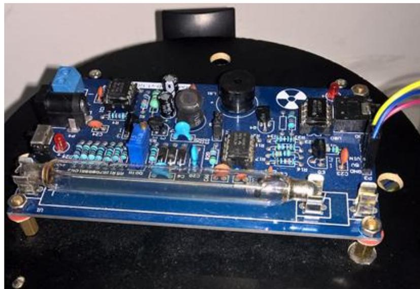
Figura. 13 – Detector Geiger-Müller equipado com tubo GM M4011.
