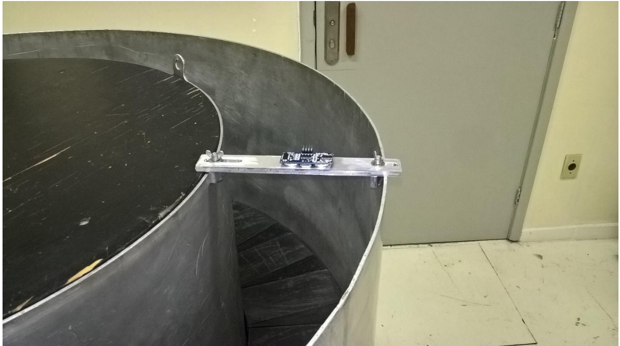
Figura 13: Sensor ultrassônico instalado no modelo teste, na Figura é possível ver o dispositivo ainda sem a capa de proteção em chumbo. O autor (2019).
