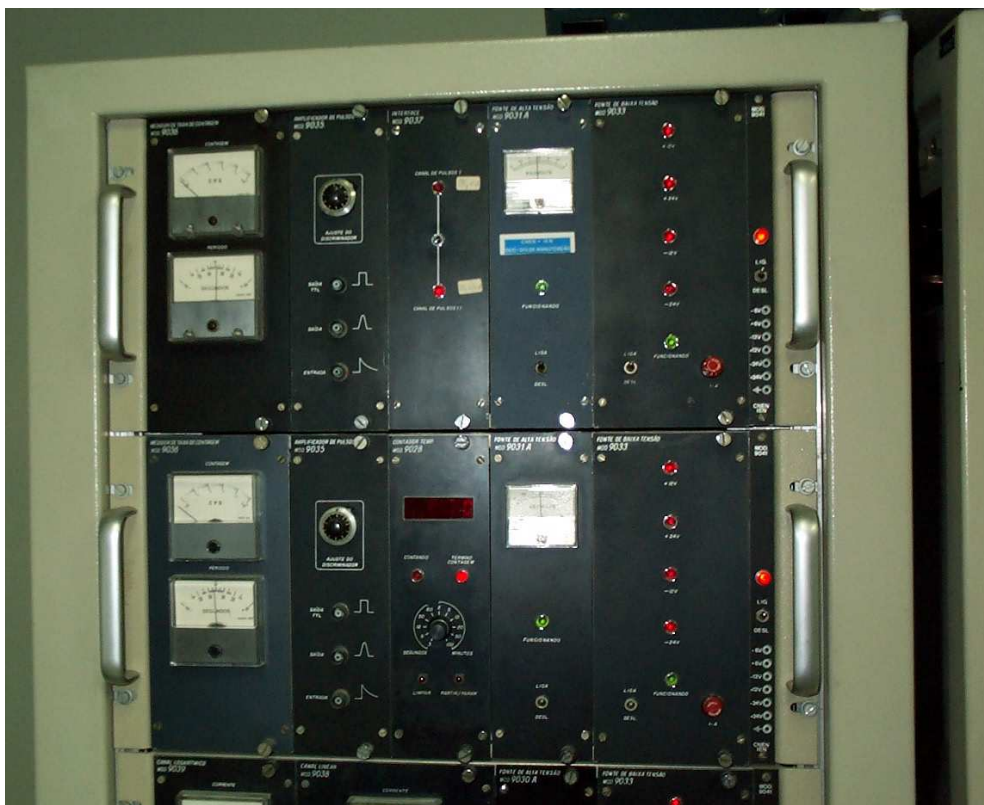
Fig. 11: Canais de pulsos (Medidor taxa de contagem, amplificador de pulsos, Contador temporizador, fonte alta tensão, fonte de baixa tensão)
