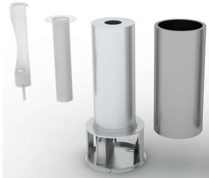
Figura 7 - Concepção do Calibrador de doses de radiofármacos Fonte: SEINS, IEN.
