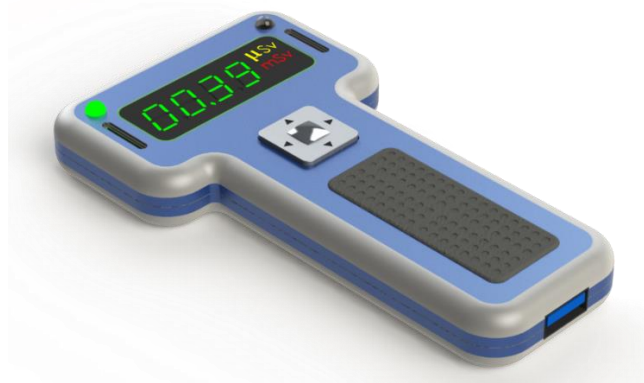
Figura 11 - Protótipo de Dosímetro baseado em diodo Fonte: SEINS, IEN
