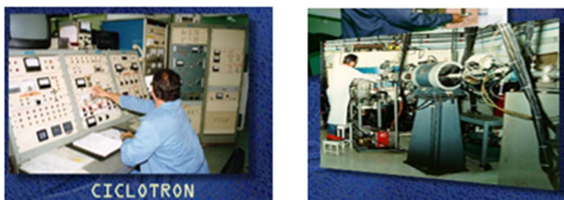
Figura 2 - Detalhe da Mesa de controle do CV-28 e linha principal de irradiação.
