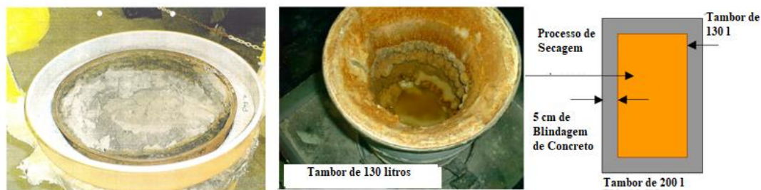
Figura 26. Embalagem utilizada no processo de secagem direta em usinas espanholas (BENAVIDES, 2001).
