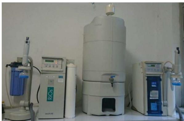
Figura 15: Sistema de purificação da água.
