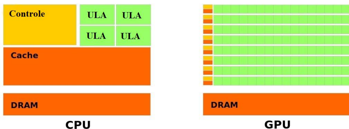
Figura. 6 – Arquitetura simplificada da CPU e da GPU
