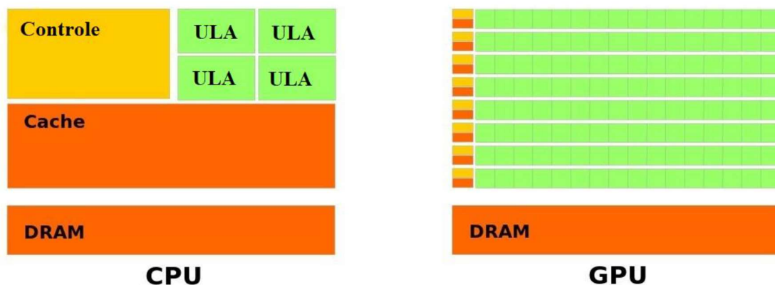
Figura 3- Diferença das Arquiteturas da CPU e da GPU.
