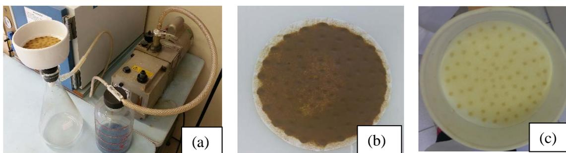
Figura 16- Montagem da aparelhagem para o pré-tratamento da água residual (a); característica do material retido nas duas etapas de pré-tratamento: (b) filtro com tamanho de poro de 8  $\mu\text{m}$  e (c) filtro com 2,5  $\mu\text{m}$ . (AUTOR, 2015)
