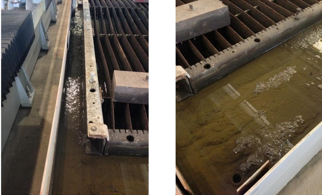
Figura 7 – Rejeitos da mesa de hidrocorte (água residual e abrasivo “Garnet”)
