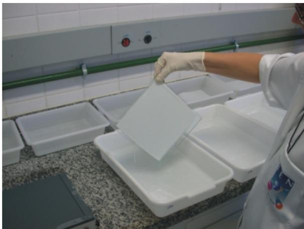
Figura 11 – Preparação de membrana polimérica pela técnica de inversão de fase (CNEN, 2007)
