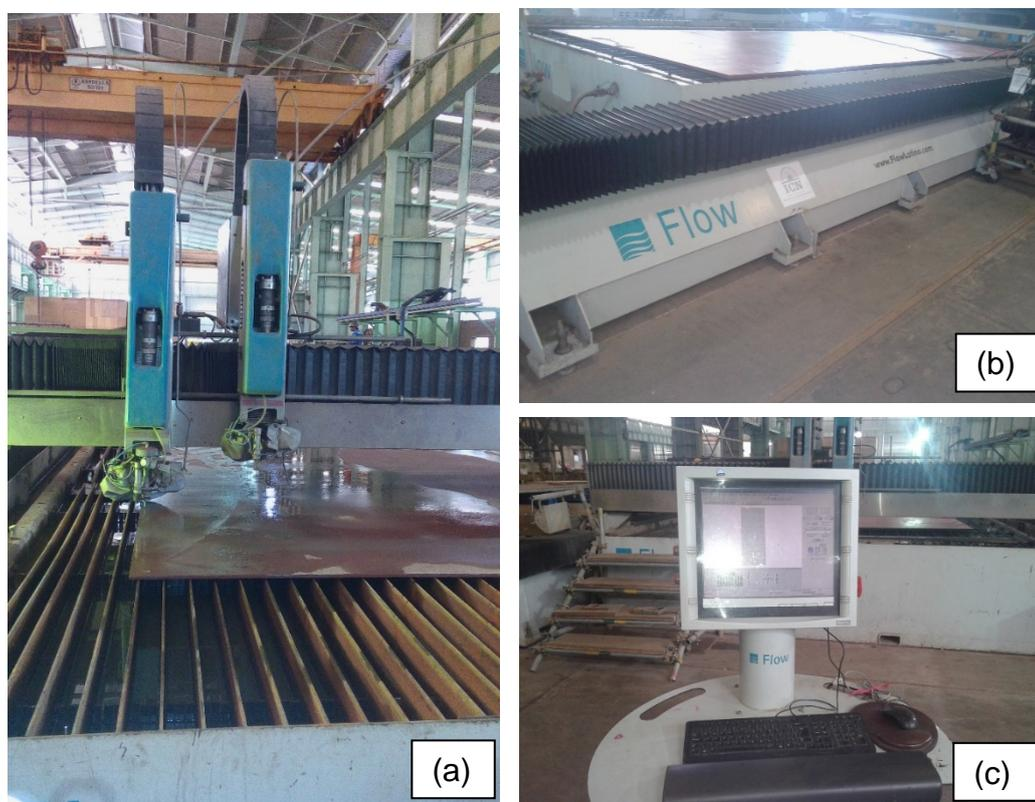
Figura 2- Detalhes da máquina de hidrocorte na NUCLEP (AUTOR, 2016):
