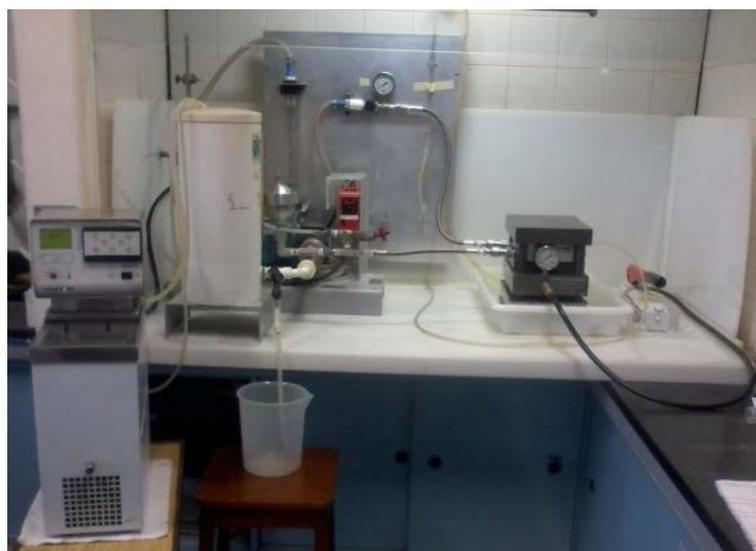
Figura 19 – Arranjo experimental utilizado nos testes de permeação da água residual da NUCLEP( AUTOR,2016)
