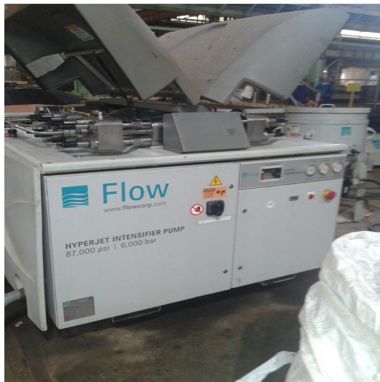
Figura 4 – Vista frontal da bomba multiplicadora de pressão na NUCLEP (AUTOR, 2016)
