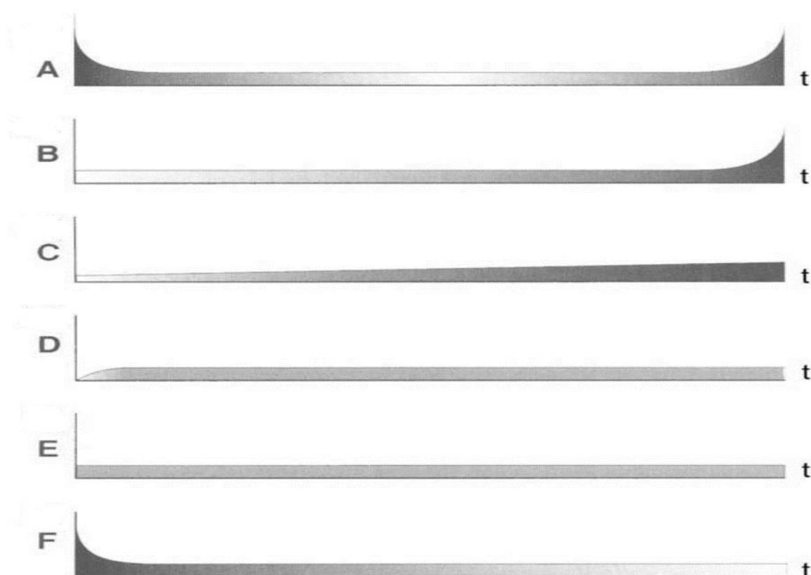
Figura 05 – Curvas Típicas de Padrões de Falhas adaptação de Smith 1993
