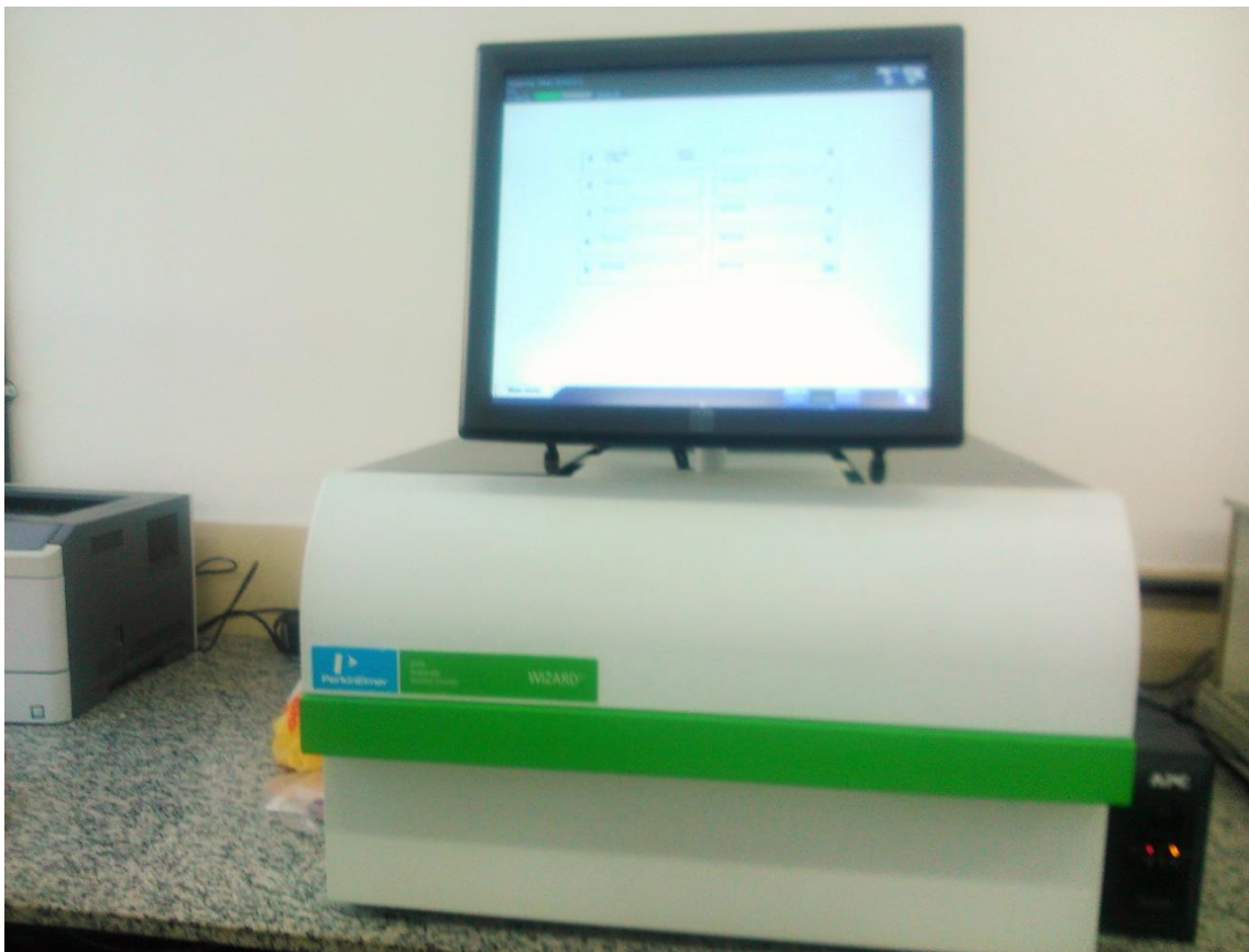
Figura 19 - Contador Gama Perkin Elmer modelo Wizard® 2470 utilizado no experimento para quantificar a radiação.
