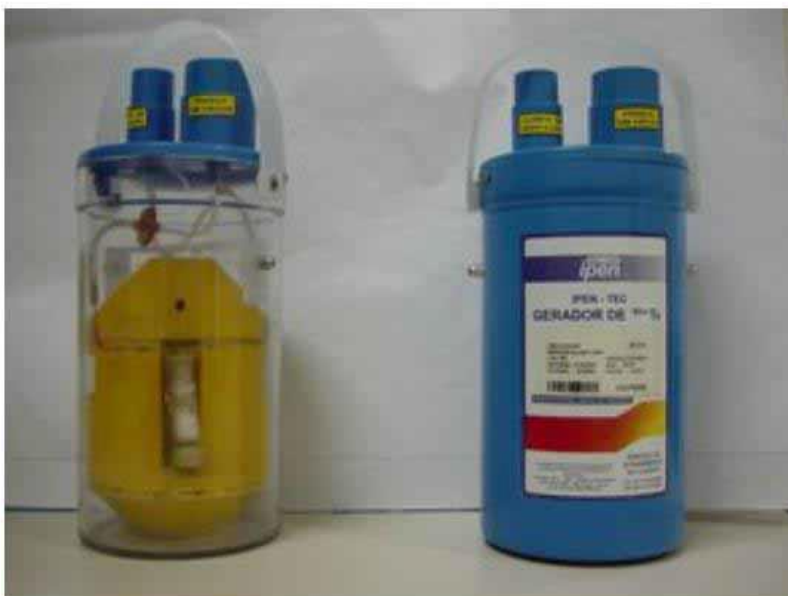
Figura 10 - Geradores de tecnécio-99m. O da esquerda, com plástico transparente, permite a observação de parte do sistema de eluição e da blindagem (Fonte: Mengatti, 2010).
