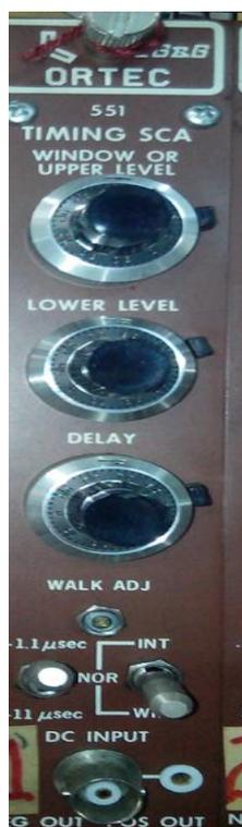
Figura 11 - Analisador Monocanal
