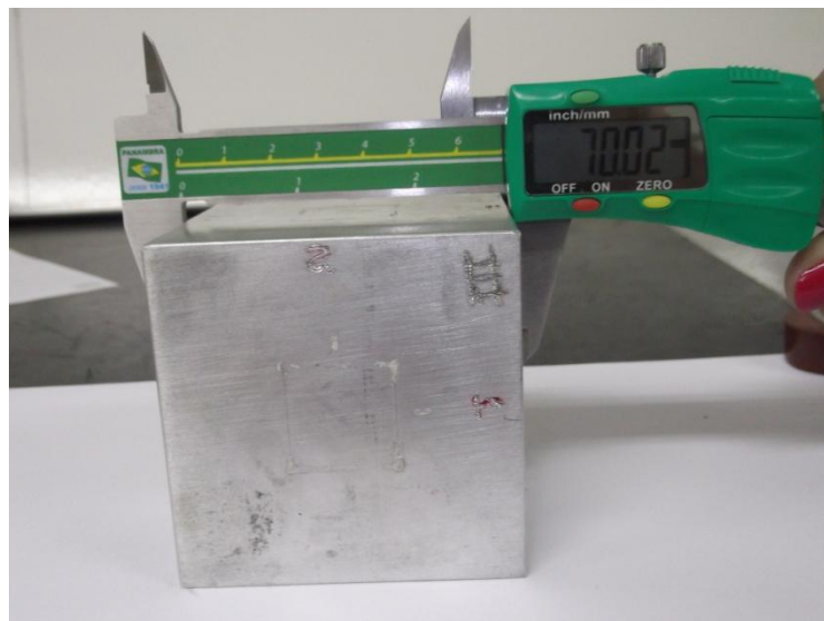
Figura 25: Verificação do espaço percorrido pela onda ultrassônica. Bloco de alumínio A6351. (da SILVA NETO. Ramiro, 2014)
