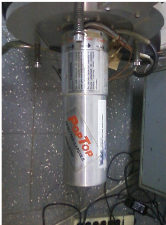
Figura 32: Visualização externa do HPGe. Este invólucro em alumínio é o chamado end cap .
