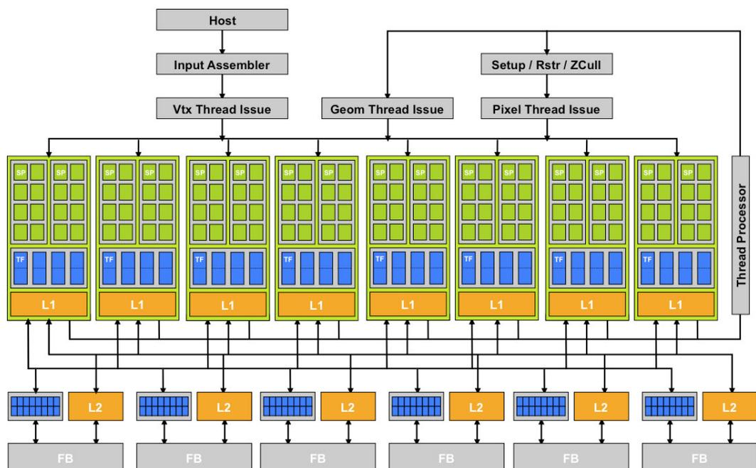
Figura 2-5 – Arquitetura da GPU GeForce 8800
