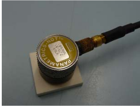
Figura 39: Técnica por contato utilizando o transdutor de onda transversal
