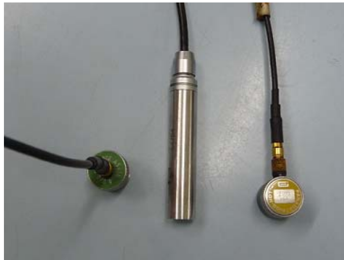
Figura 32: Transdutores ultra-sônicos utilizados nos experimentos
