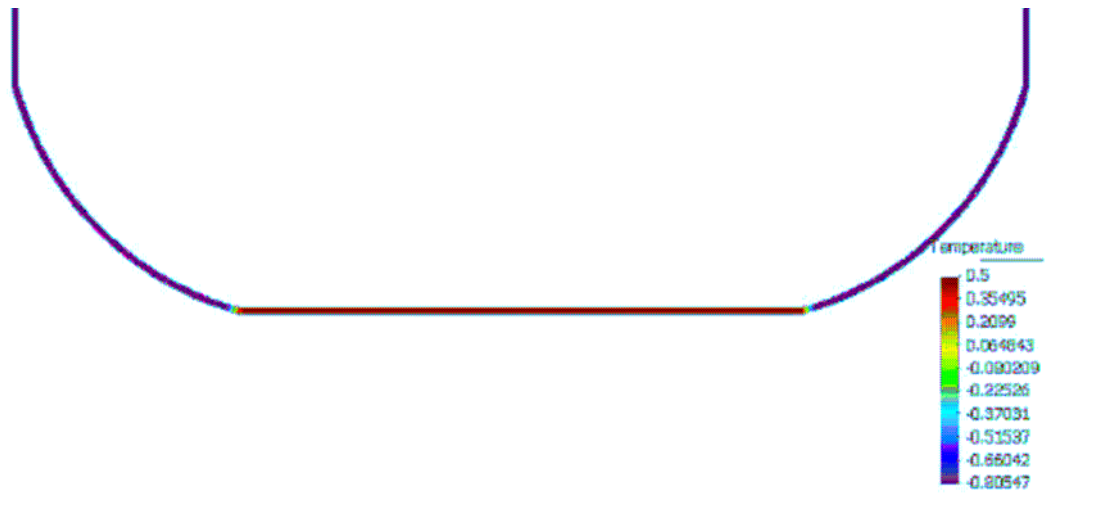
Figura 15 Detalhe da malha de elementos finitos na parte inferior do loop referente ao aquecedor e seu valor inicial;
