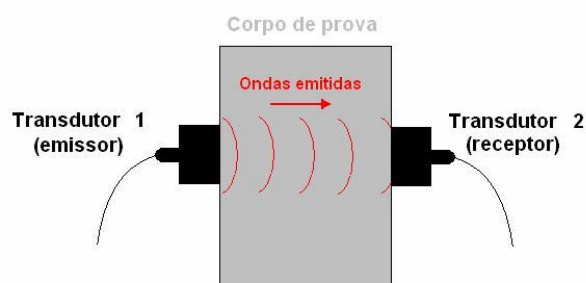
Figura 2.7: Representação esquemática da técnica ultrassônica de transmissão [BARONI, 2008].
