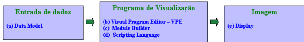
Figura 2.1: Esquema sintético de funcionamento do OpenDX
