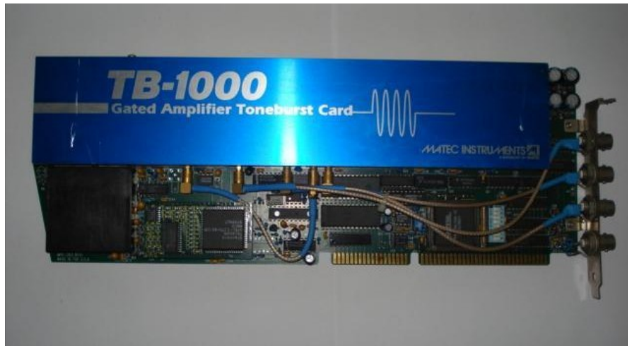
Figura 4.5: Foto da placa geradora de sinal ultra-sônico TB1000.
