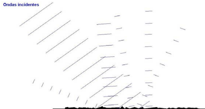
Figura 2.3: Reflexão difusa devido a rugosidade da superfície refletora.
