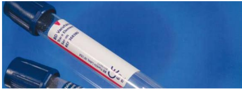
Figura 2 - Frasco de coleta próprio para análise de elementos traços em soro sanguíneo (BD Vacutainer® Trace Element Serum).
