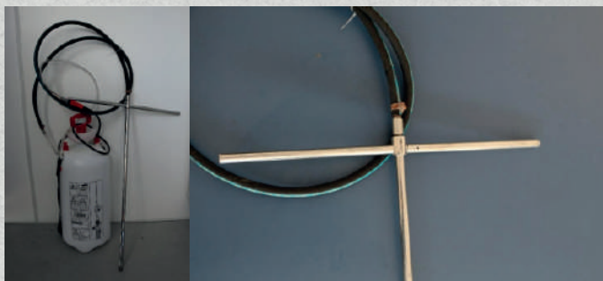
Figura 2. Bomba de aspersão de jardim conectada à agulha (A); Detalhe de conexão agulha/bomba (B). Foto: Cristiane Kolesnikovas.
