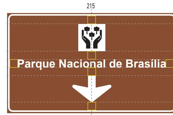
A borda inferior da placa colocada lateralmente à pista deve ficar a uma altura livre mínima de 2,10m em relação à superfície da calçada ou canteiro central. Para as placas suspensas sobre a pista, a altura livre mínima deve ser de 4,80m, a contar da borda inferior. Em vias com tráfego de veículos com altura superior a 4,70m, a altura livre mínima da placa deve ser de 5,50m.
