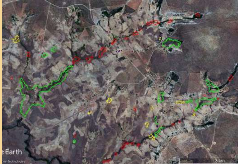
Figura 32 -Objetos criados automaticamente e associados a potenciais depressões no terreno que posteriormente são classificados com o uso de imagens e validados em campo. Em verde, amarelo e vermelho observa-se depressões classificadas em prováveis, suspeitas e negativos, respectivamente.
