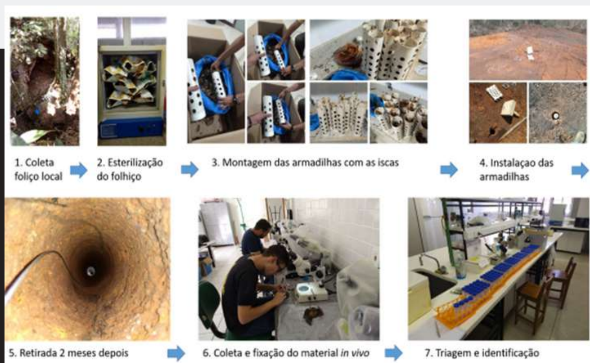
Figura 28 - Sequência do desenvolvimento experimental para a amostragem biológica em furos
