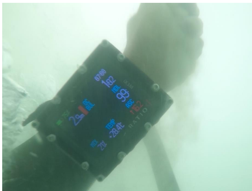
Figura 3. Determinação da profundidade utilizando o computador de mergulho Ratio Tech+.
