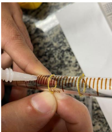
Figura 30 - Confecção da marcação na pipeta
