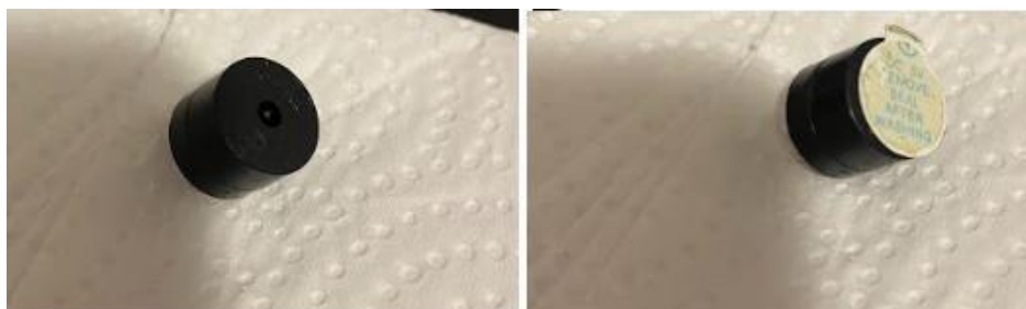
Figura 44 - Abafando o som do buzzer
