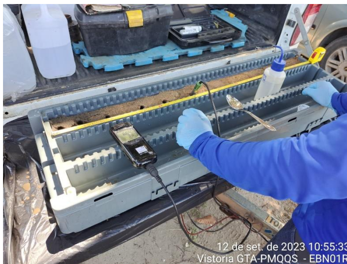
Figura 4. Medição dos parâmetros pH, ORP e temperatura no testemunho de sedimento no ponto EBN01R.
