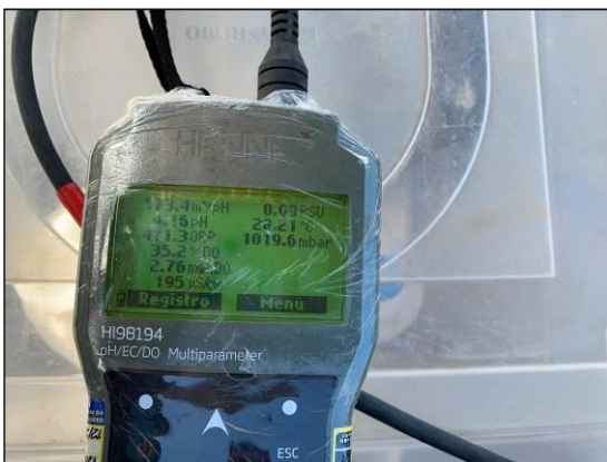
Figura 9. Medição de parâmetros físico-químicos medidos in situ com sonda multiparamétrica no ponto ERR 01R.
