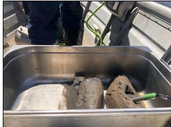
Figura 3. Medição de pH, temperatura e potencial redox do sedimento coletado no ponto ERD 01R.
