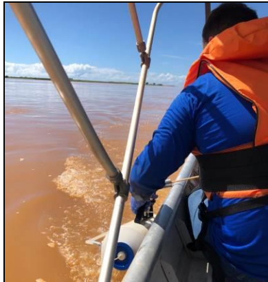
Figura 2. Coleta de amostra de água do ponto ERD 01R com garrafa de van dorn.
