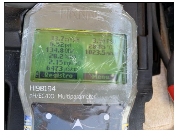
Figura 36. Medição com multiparâmetro, in situ , de parâmetros físico-químicos no ponto EIT 01.
