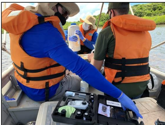
Figura 39. Medição de turbidez no ponto EIT 02 e envasamento de amostras de água.
