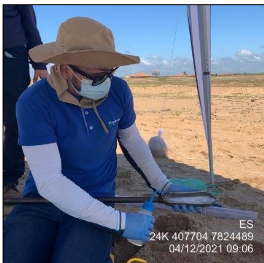
Foto 7. Limpeza do trado holandês simples com bucha, detergente extran e água destilada.
