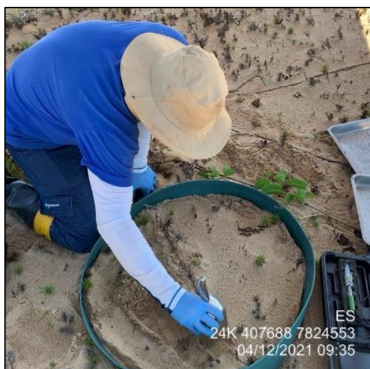
Foto 1. Retirada da camada superficial (0-2 cm) com colher de inox em ponto delimitado localizado na restinga.
