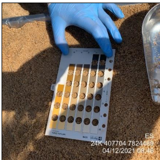
Foto 3. Análise de coloração de amostra de sedimento de acordo com a escala Munsell.
