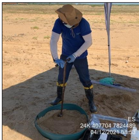
Foto 6. Coleta de amostra de sedimento em camadas acima de 5 cm com trado holandês simples.
